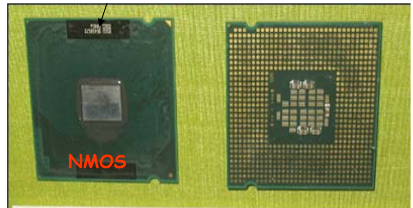
Intel Pentium 4 65 nm (Cedar Mill) 3,3 GHz
