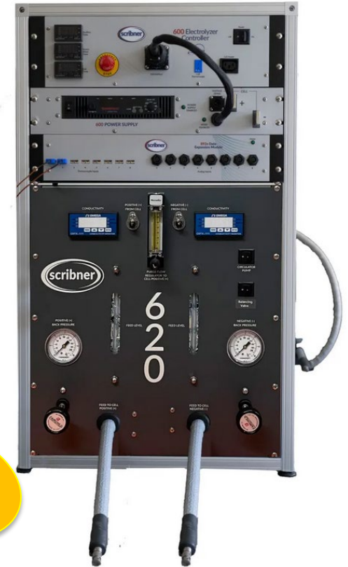
Banc de test Electrolyse = Générateur d'hydrogène
